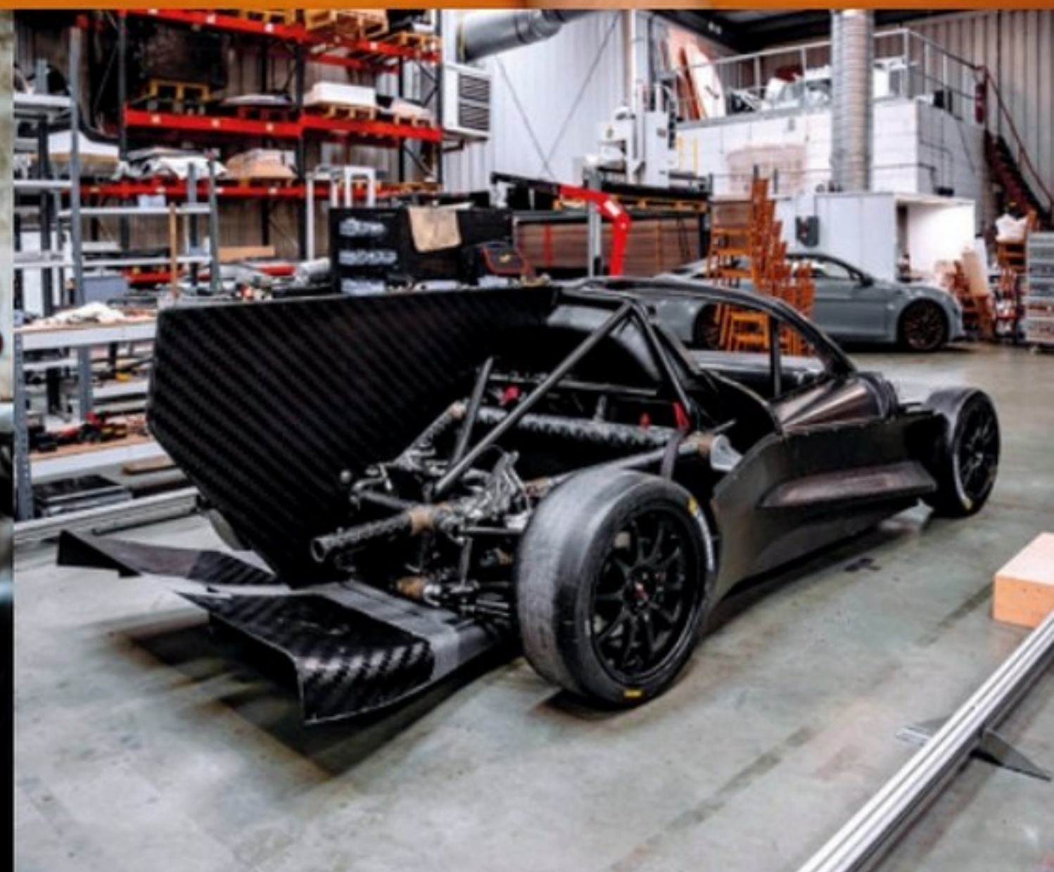
Le châssis carbone au procédé spécifique ne pèse que 35 kg !
